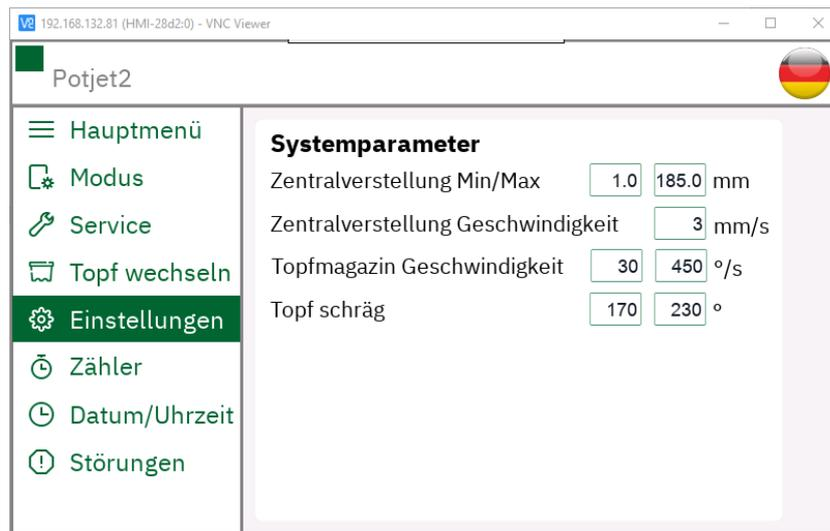
**Zentralverstellung Min/Max:** Die untere und obere Grenze der Position der Zentralverstellung.
